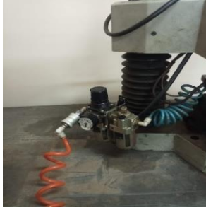
صورة 4 ركز على نظام الضغط. تمت الإشارة إلى هذا باعتباره الجزء الأكثر ضعفاً في المعدات
