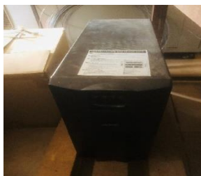
Images 20 et 21 : Les photos ci-dessus montrent les deux onduleurs qui sont tombés en panne à la suite d'une surtension. L'onduleur blanc a été le premier à être remplacé par l'onduleur noir, qui a lui aussi explosé.
