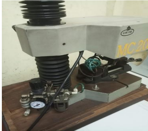
Image 7 : La machine de marquage au Rwanda dont le manomètre est cassé, et le tuyau est également endommagé.
