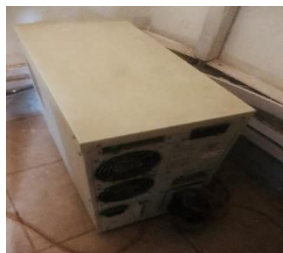
Images 20 et 21 : Les photos ci-dessus montrent les deux onduleurs qui sont tombés en panne à la suite d'une surtension. L'onduleur blanc a été le premier à être remplacé par l'onduleur noir, qui a lui aussi explosé.
