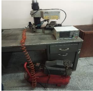
صورة 4 ركز على نظام الضغط. تمت الإشارة إلى هذا باعتباره الجزء الأكثر ضعفاً في المعدات
