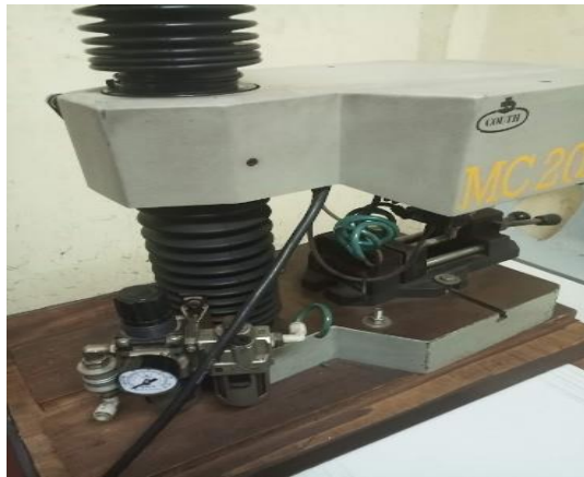
الصورة 7: آلة الوسم في رواندا التي تم كسر مقياس ضغطها، وتلف الأنبوب أيضاً.
